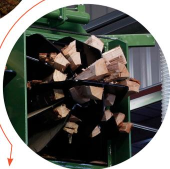
**3 Séchage :** séchage des bûches jusqu'à obtenir un taux d'humidité inférieur à 20 %. La chaufferie est alimentée à 100 % par les produits connexes.
