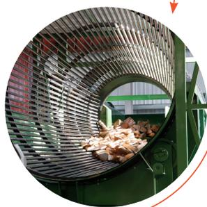
**4 écorçage :** la bûche est nettoyée en tambour d'écorçage.
